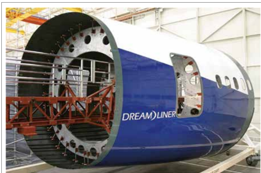
Fig.1: Sezione di fusoliera del Boeing 787
