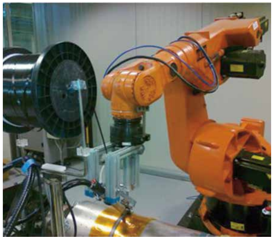
Fig.7: Setup sperimentale per il fiber placement, allestito dal CIRA, socio di IMAST
