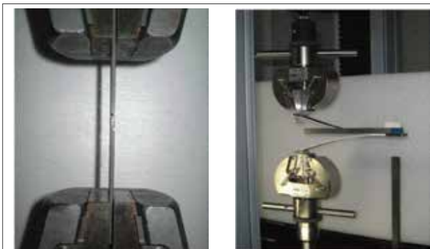
Fig.10: Analisi SLS ASTM D3165-07 (sinistra) e DCB ASTM D5528-01 (destra) dei provini incollati
